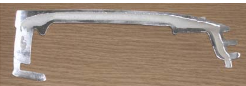
Bild 15: Durch Gasinjektion hohl gegossenes Magnesiumdruckgussteil
