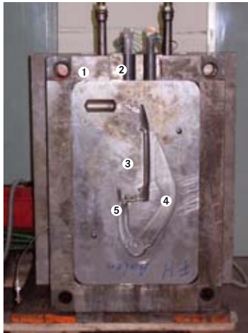
1. Nebenkavität, 2. Verschlussstift, 3. Injektor, 4. Gießlauf 1, 5. Gießlauf 2
