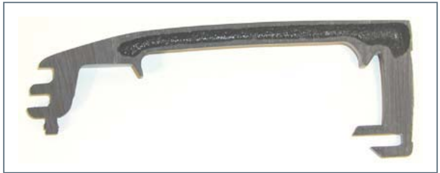
Bild 1: Mit Hilfe der Gasinjektion hergestellter PKW-Türgriff aus glasfaserverstärktem Polyamid
