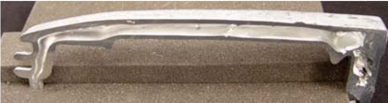
Bild 13: Zinkdruckgussteil mit vollständigem, durch Gasinjektion gebildetem Hohlraum
