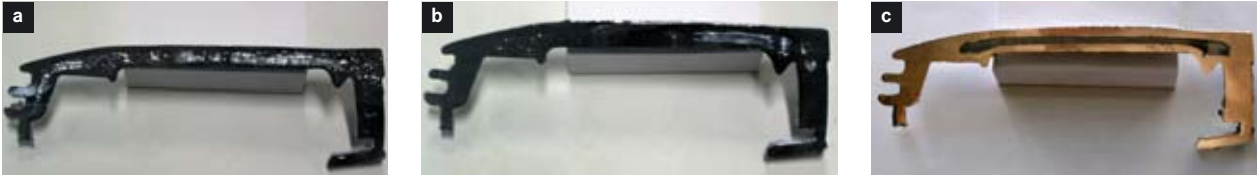
Bild 12: Mögliche Fehlerquellen beim Druckgießen mit Gasinjektion: a) Gasinjektion bei mittigem Anschnitt; b) Gasinjektion beginnt zu spät; c) Formtemperatur zu gering
