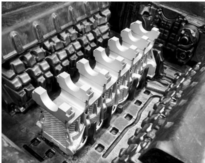
Bild 3: Magnesium-Aluminium-Verbundkurbelgehäuse mit in das Druckgießwerkzeug eingelegtem Aluminiuminsert
